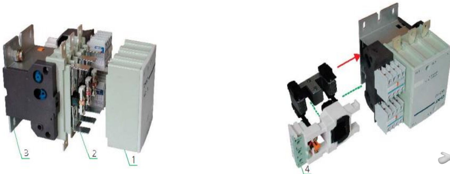
1: Дугогасительная система 2: Контактная система 3: Основание 4: Магнитная система
